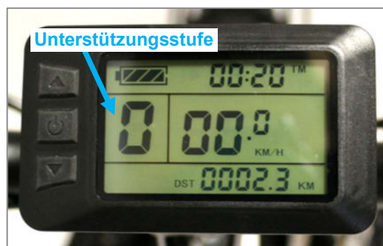
Abbildung 32: Display eingeschaltet; Anzeige der Unterstützungsstufe auf dem Display (Unterstützungsstufe 0)
