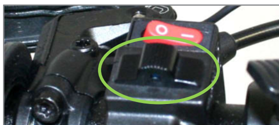
Abbildung 34: Schalter in mittlerer Position (Vorwärtsgang)
