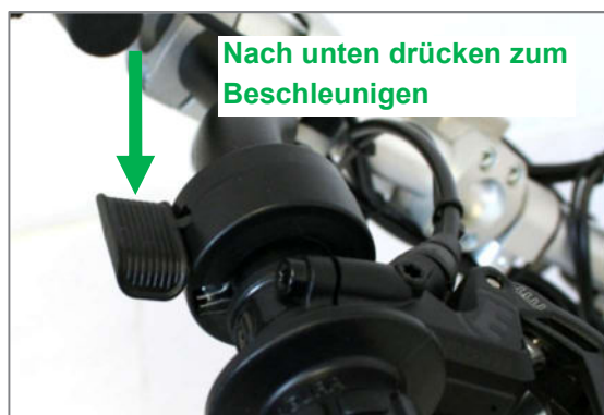
Abbildung 38: Fahrtsignalgeber zum Beschleunigen nach unten drücken
