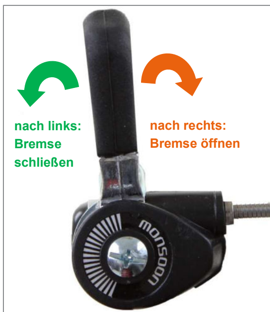
Abbildung 24: Rasthebel der Feststellscheibenbremse
