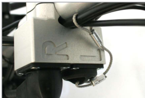
Abbildung 26: Buchsenhalter an der Lenksäule mit Kennzeichnung „R“ für rechten Akku und „L“ für linken Akku (Ansicht von oben)
