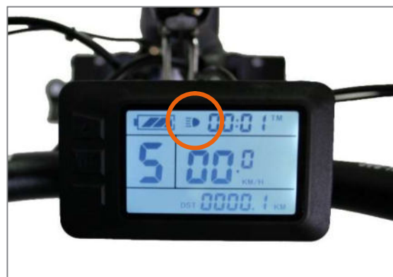
Abbildung 50: Displayanzeige bei eingeschaltetem Licht
