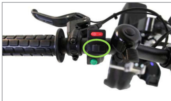
Abbildung 33: Schalter am Lenker zum Einlegen des Rückwärtsgangs
