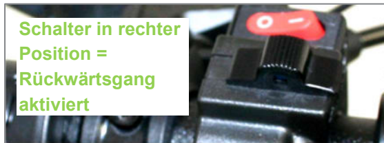
Abbildung 43: Schalter am Lenker in rechter Position; Rückwärtsgang ist aktiviert
