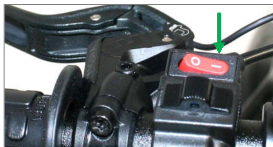
Abbildung 6: Modus [I] = Maximalgeschwindigkeit von 15 km/h oder 24 km/h
