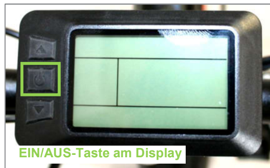
Abbildung 31: EIN/AUS-Taste am Display
