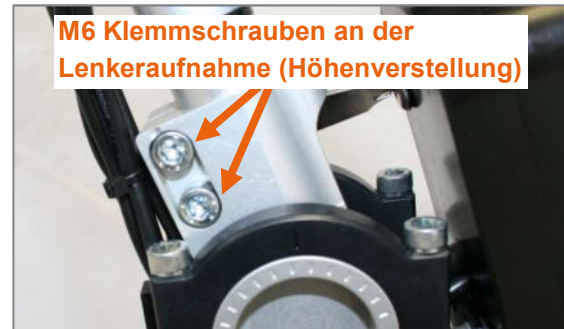
Abbildung 18: M6 Klemmschrauben für die Höhenverstellung der Lenkerposition
