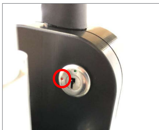
Abbildung 5: Schlüsselposition „rot“ = Maximalgeschwindigkeit von 6 km/h oder 15 km/h (Schweiz: 10 km/h)
