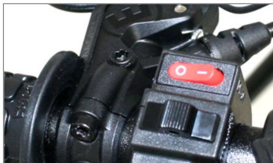
Abbildung 3: Roter Schalter für den Wechsel zwischen Normal-Modus [0] und Sport-Modus [I]
