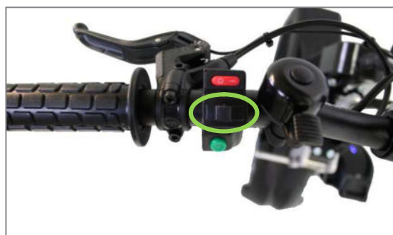
Abbildung 41: Schalter am Lenker zum Einlegen des Rückwärtsgangs
