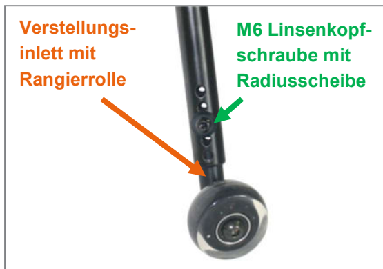
Abbildung 16: M6 Linsenkopfschraube mit Radiusscheibe und Verstellungsinlett zur Höheneinstellung des Abstellständers
