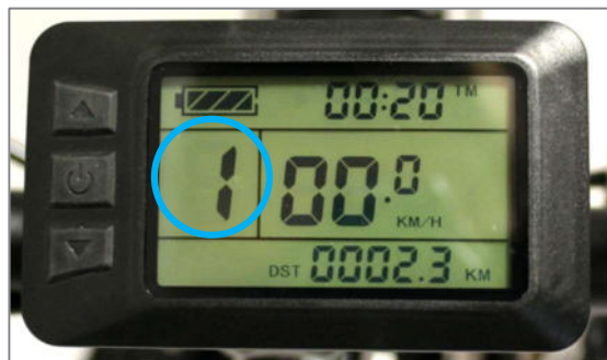
Abbildung 36: Anzeige der Unterstützungsstufe auf dem Display (Unterstützungsstufe 1)
