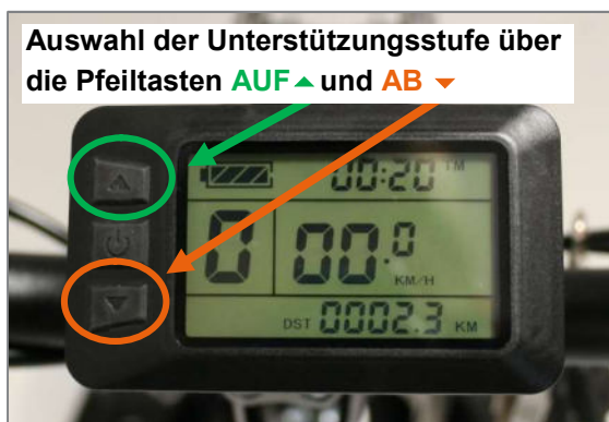
Abbildung 35: Auswahl der Unterstützungsstufe am Display
