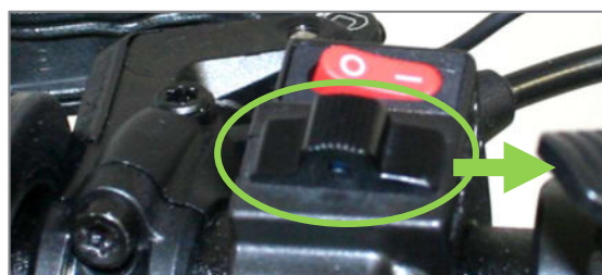
Abbildung 42: Schalter am Lenker (auf der in Fahrtrichtung linken Seite) zum Einlegen des Rückwärtsgangs nach rechts schieben
