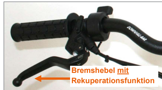
Abbildung 46: Mit Bremssensor ausgestatteter Bremshebel mit Rekuperationsfunktion während des Bremsvorgangs
