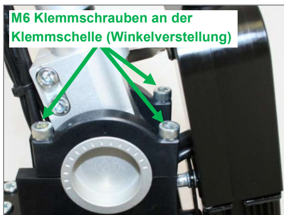
Abbildung 17: M6 Klemmschrauben für Winkelverstellung der Lenkerposition
