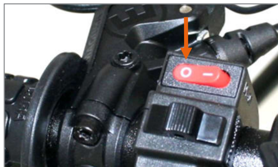
Abbildung 4: Modus [0] = Maximalgeschwindigkeit von 6 km/h oder 15 km/h (Schweiz: 10 km/h)
