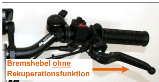
Abbildung 20: Bremshebel links ohne Rekuperationsfunktion
