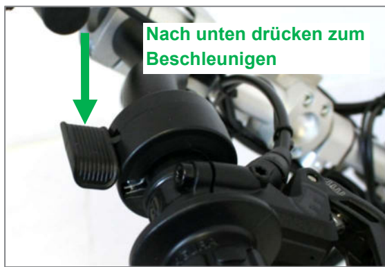
Abbildung 44: Fahrtsignalgeber zum Beschleunigen nach unten drücken
