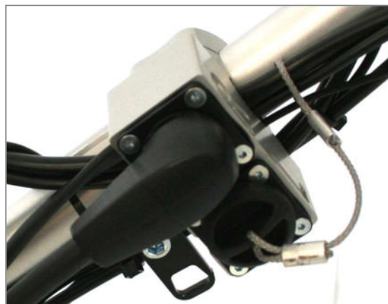
Abbildung 27: Rechter Akku angeschlossen; Magnetstecker in Buchse „R“
