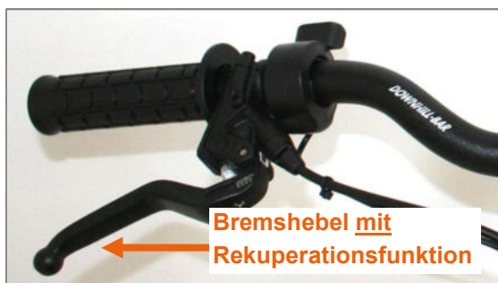
Abbildung 21: Bremshebel rechts mit Rekuperationsfunktion
