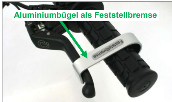
Abbildung 23: Aluminiumbügel als Feststellbremse
