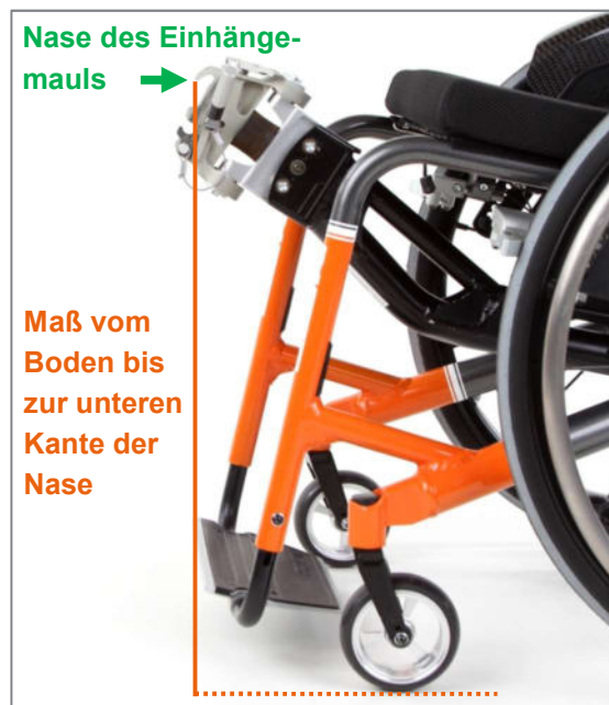
Abbildung 14: Maß vom Boden bis zur unteren Kante der Nase des Einhängemauls
