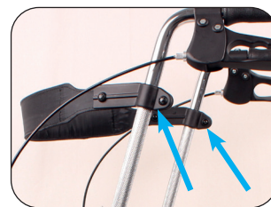
Stel de gewenste riemhoogte in en draai de schroeven van de buisklemmen vast
