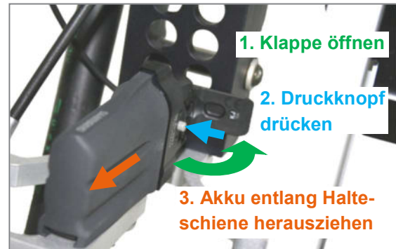
Abbildung 21: Akku zum Laden entnehmen
