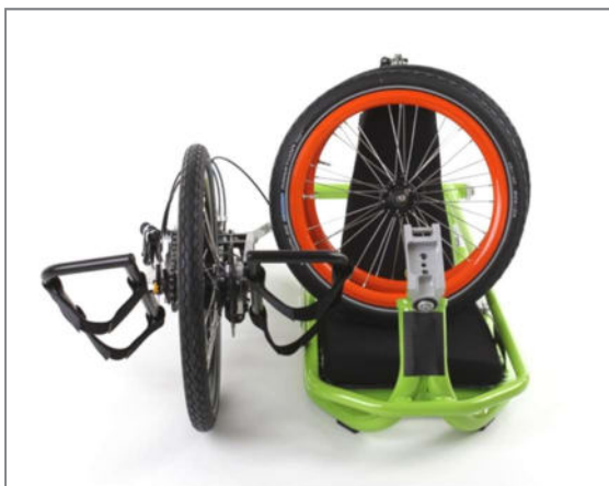
Abbildung 67: Packmaß: Chassis und Antriebseinheit getrennt und Laufräder abgenommen
