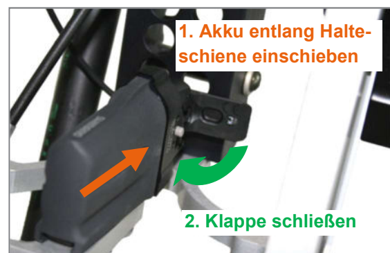
Abbildung 23: Akku nach dem Laden wieder anschließen
