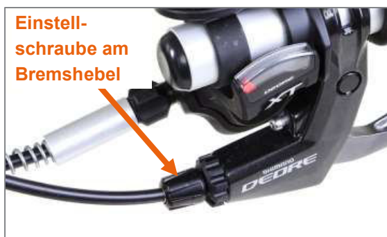
Abbildung 28: Einstellschraube am Bremshebel
