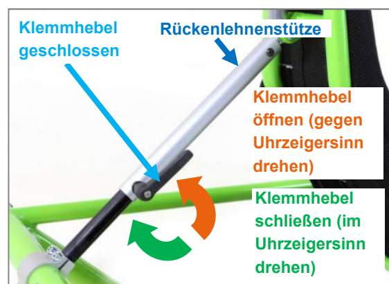
Abbildung 33: Winkelverstellung der Rückenlehne über Klemmhebel
