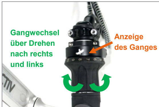
Abbildung 16: Schalten über Drehgriff bei Rohloff Nabenschaltung
