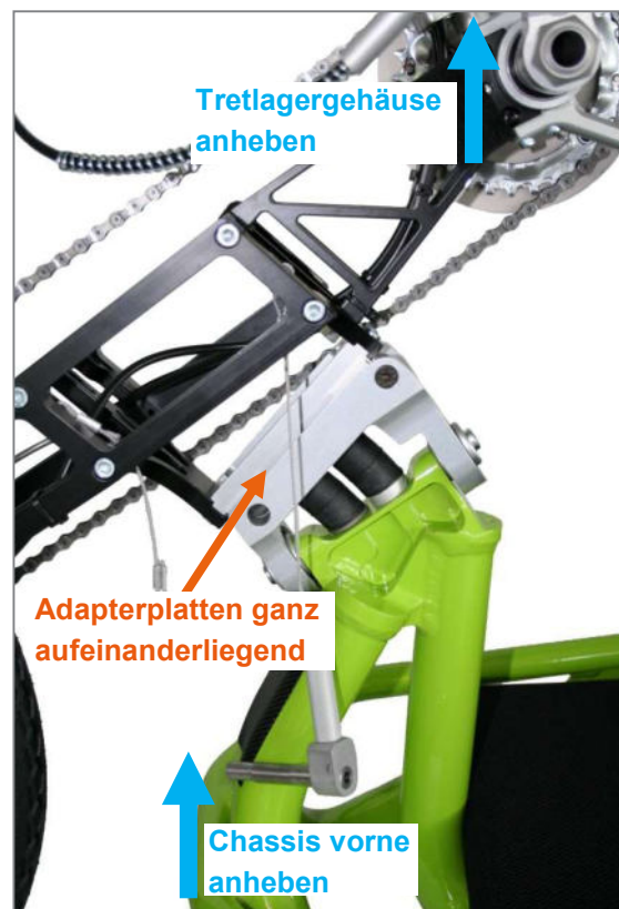
Abbildung 61: Adapterplatten von Antriebseinheit und Chassis aufeinander liegend
