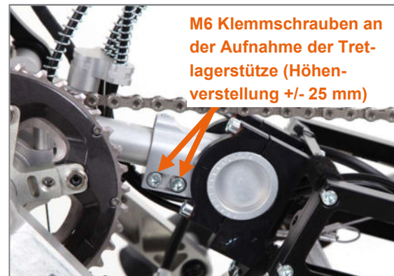
Abbildung 8: M6 Klemmschrauben für die Höhenverstellung der Tretlagerposition
