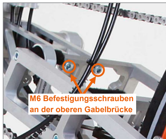
Abbildung 5: M6 Befestigungsschrauben an der oberen Gabelbrücke
