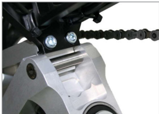
Abbildung 59: Einhängemaule der Antriebseinheit rutscht unter die Einhängewelle am Chassis
