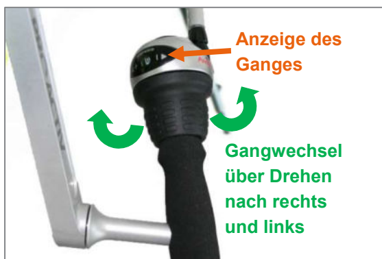
Abbildung 17: Schalten über Drehgriff bei Shimano Nexus Nabenschaltung
