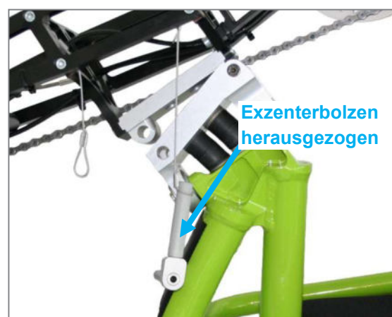
Abbildung 65: Exzenterbolzen aus den Adapterplatten herausgezogen, Chassis auf Boden abgelassen
