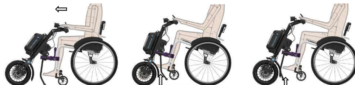
Abbildung 38 Parking (1), City (3) und Touring (2) Positionen für Geräte mit manueller Klemme/Heber
