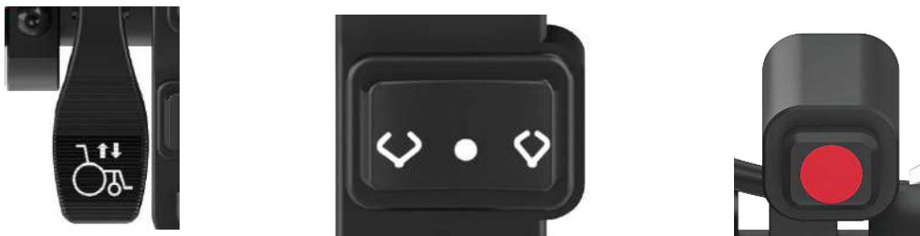
Abbildung 37 Hebel der Handhebevorrichtung, Taste für automatische Klemmvorrichtung/Hebevorrichtung und Aktivierungstaste
