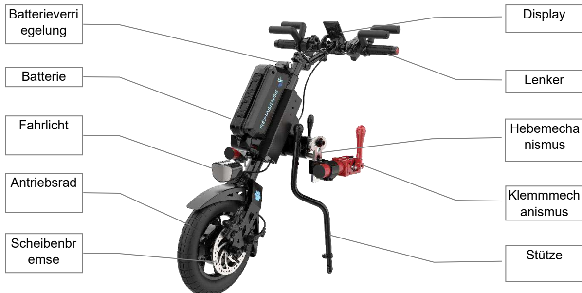
Abbildung 1 Hauptelemente des Geräts (Beispiel zeigt manuelle Konfiguration der Klemme und des Hebers)
