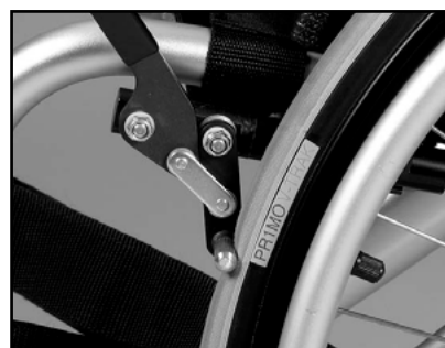
Abbildung 44 Die Radsperren üben den korrekten Druck aus
