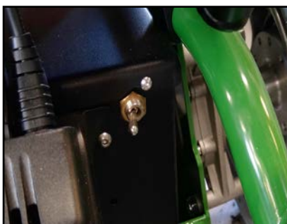
Image 43: Switch for the fan
