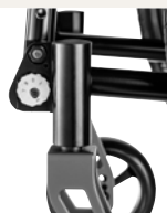
Einstellung der vorderen Lenkräder Exzentrische Einstellung des Lenkrädergehäuses
