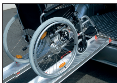
Met lage snelheid en zonder accelereren de oprijplaat oprijden.
